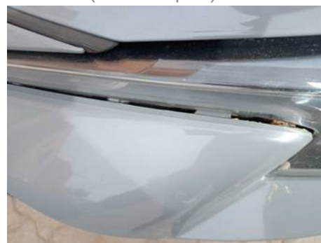
Bouclier avant (Défaut aspect)
